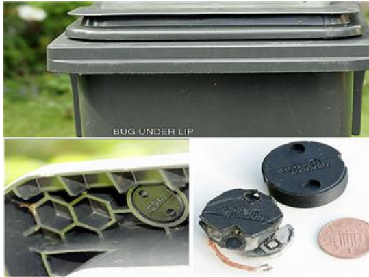
Tag passif se trouvant dans le couvercle d'une poubelle
